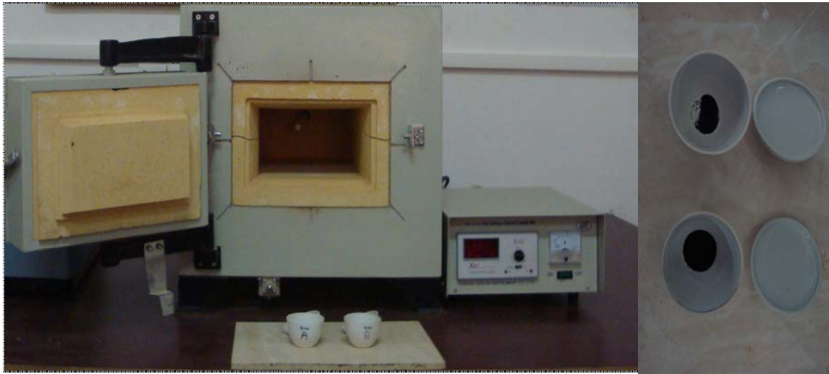
الشكل (5a) عملية وضع بودقات السناج داخل الفرن الكهربائي
