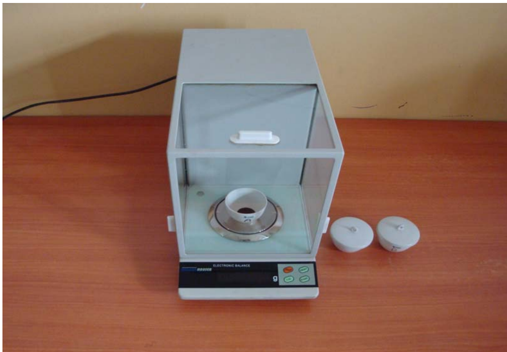
الشكل (5b) قياس وزن السناج قبل وبعد عملية الأكسدة
